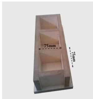
شکل ۱- قالب نمونه‌های بتنی
